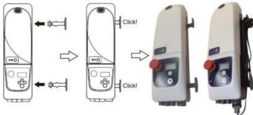
Εικόνα 5. Σχέδιο εγκατάστασης αγκίστρων για το καλώδιο τροφοδοσίας.
