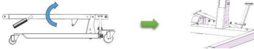
Εικόνα 2. Σχέδιο τοποθέτησης της ανυψωτικής στήλης.
