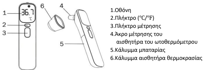
Σχήμα 3.2 ο αισθητήρας υπέρυθρης θερμοκρασίας
